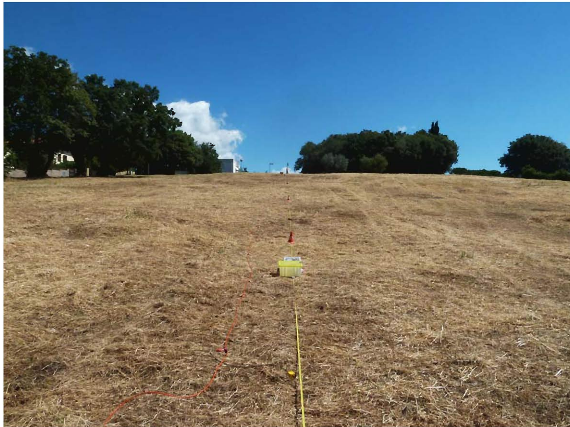
Indagine in sismica a rifrazione in onde P – Sez.3 - Documentazione fotografica.
