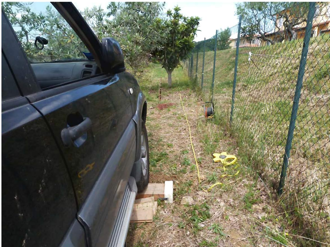
Indagine in sismica a rifrazione in onde Sh – Sez.2 - Documentazione fotografica.
