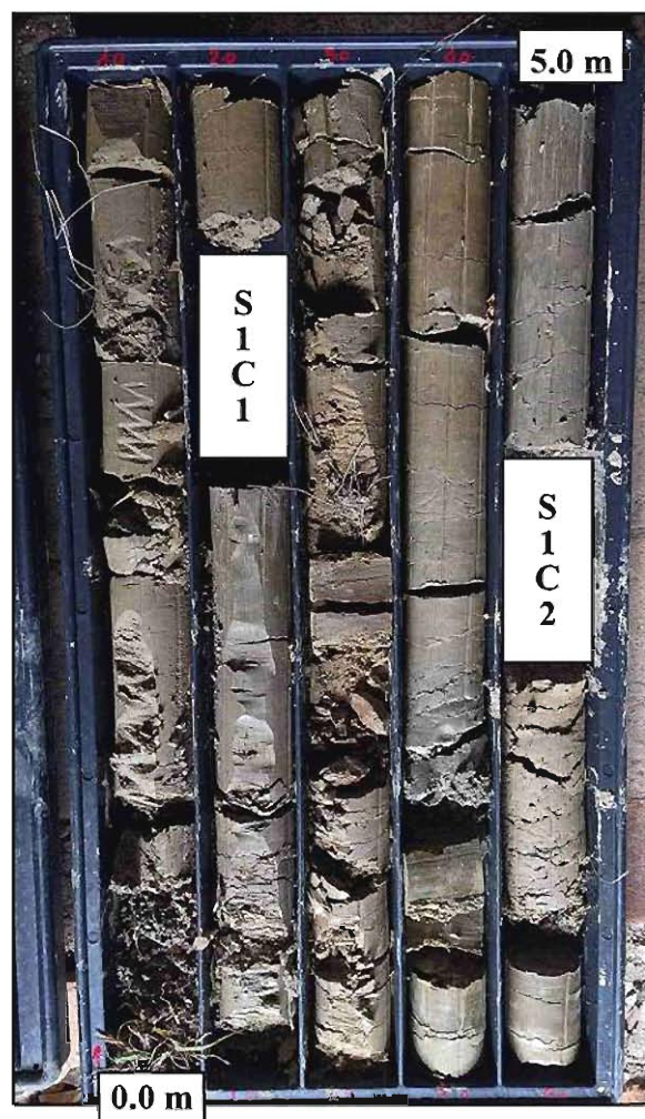
Foto 5a-b: stratigrafia del sondaggio S1-2018 (0,0 - 10,0 metri a carotaggio continuo).
