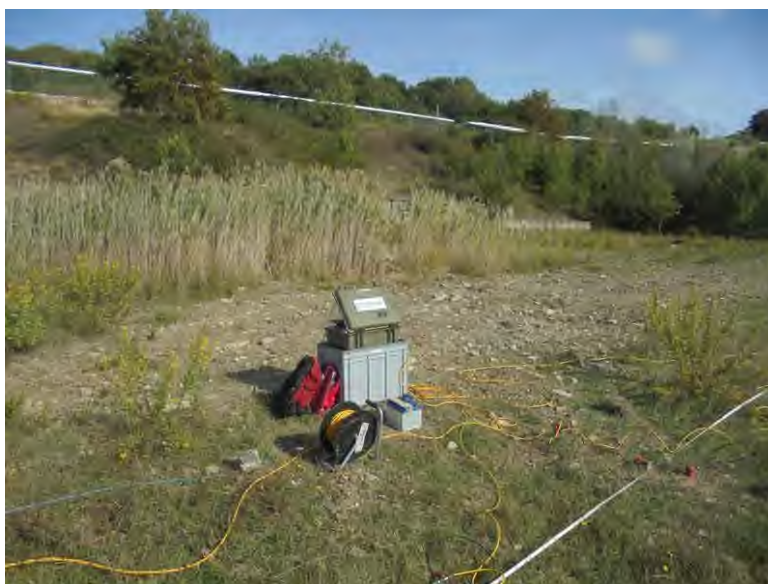
Fig. 7.5 – Postazione Padule 2. Pomarance (PI). Foto del profilo sismico a rifrazione SRT2.
