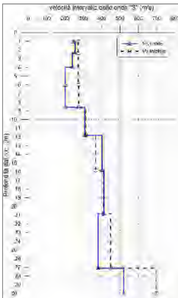
Fig. 9.9 – Indagine MASW. Profilo MW-1. Profilo verticale della velocità delle onde S.
