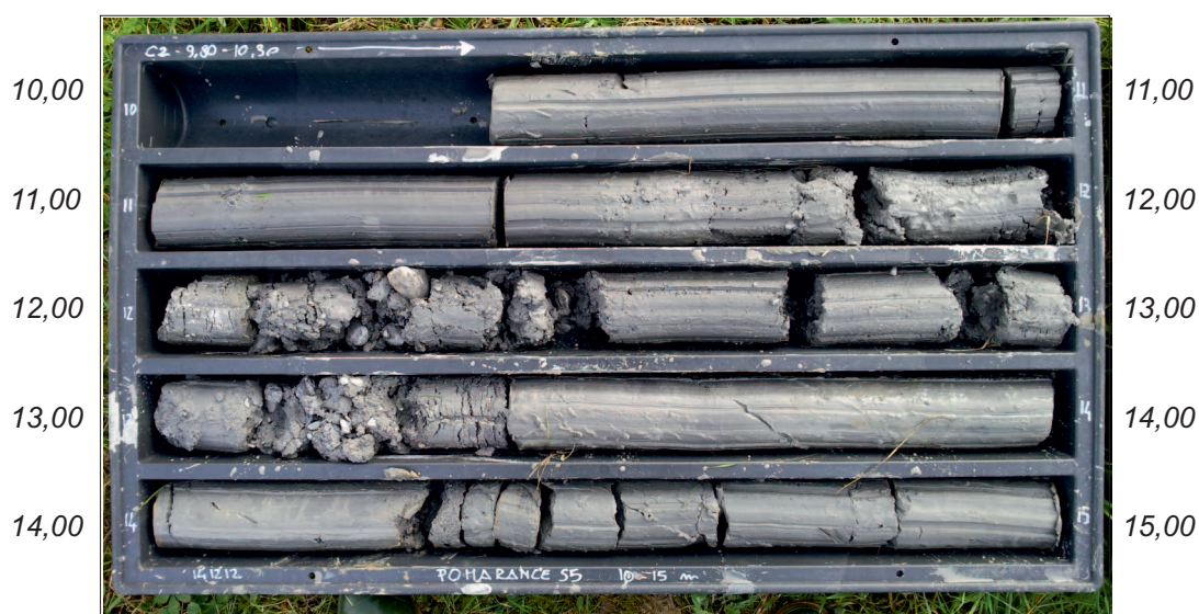
SONDAGGIO S5 - Cassetta 3: da 10,00 m a 15,00 m
