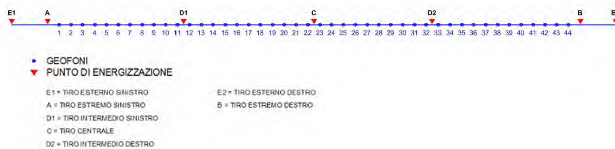
Fig. 7.2 – Tomografia sismica. Disposizione dei siti di energizzazione.
